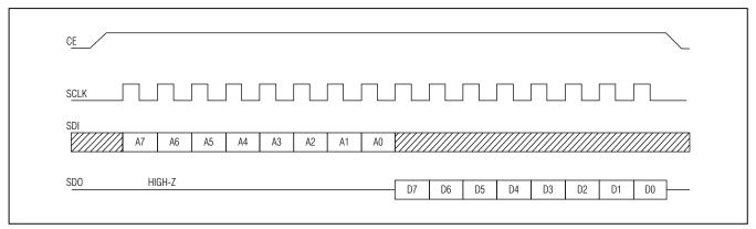
Figure 8. SPI Single-Byte Read
