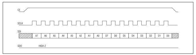
Figure 9. SPI Single-Byte Write
