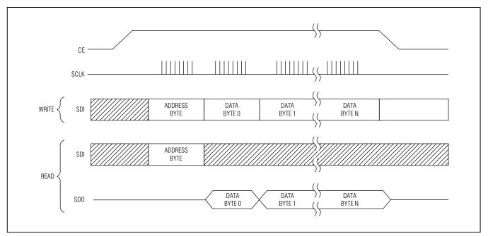
Figure 10. SPI Multiple-Byte Burst Transfer
