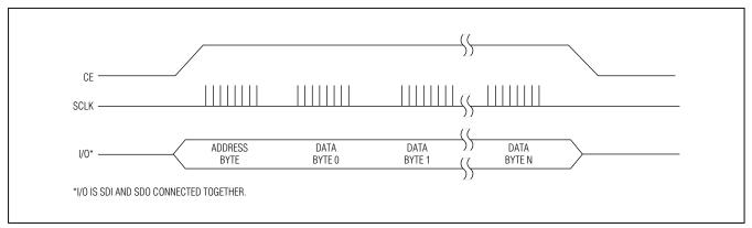
Figure 12. 3-Wire Multiple-Byte Burst Transfer
