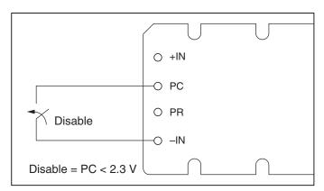
Figure 2 — Module enable/disable.
