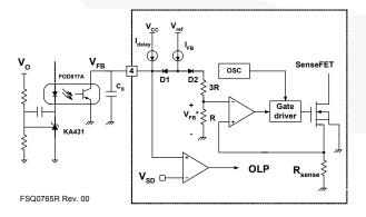
Figure 32. Pulse-Width-Modulation (PWM) Circuit
